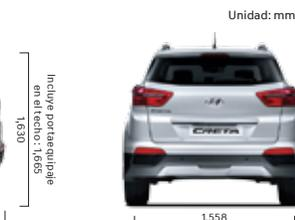
\*Rodadura: 16" (delantera y trasera) - 1,557 / 1,570 17" (delantera y trasera) - 1,545 / 1,558
