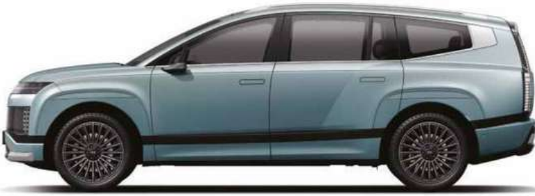
Distancia entre ejes 3,130 Longitud total 5,060
